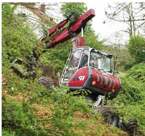
Photo 1 Pelle araignée en action dans les bois et broussailles
